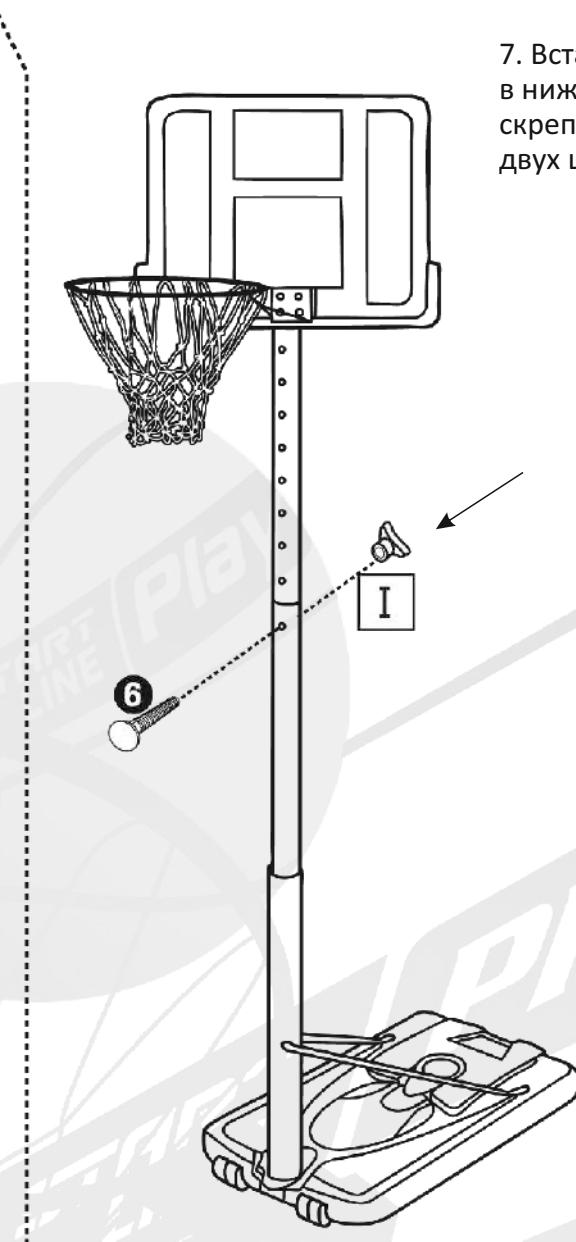
7. Вставьте среднюю стойку в нижнюю стойку, скрепите с помощью болта(4), двух шайб (O-2) и гайки (N-2).
