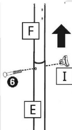
5. Вставьте верхнюю стойку (F) в среднюю стойку (E) так, чтобы она выступала сверху. Закрепите две стойки с помощью болта (6) и треугольной гайки(I).
