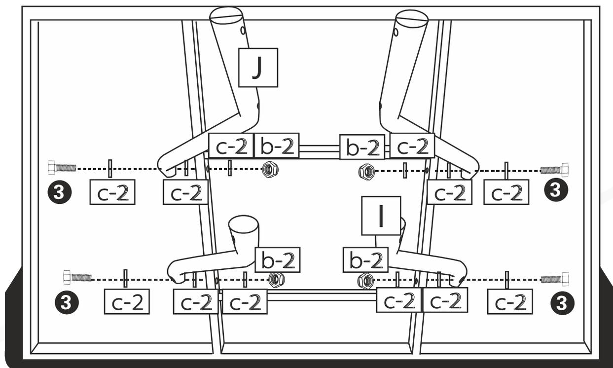
1. Установите верхние (J) и нижние (I) рычаги к щиту, используя четыре болта (№3), двенадцать шайб (c-2) и четыре гайки (b-2).
