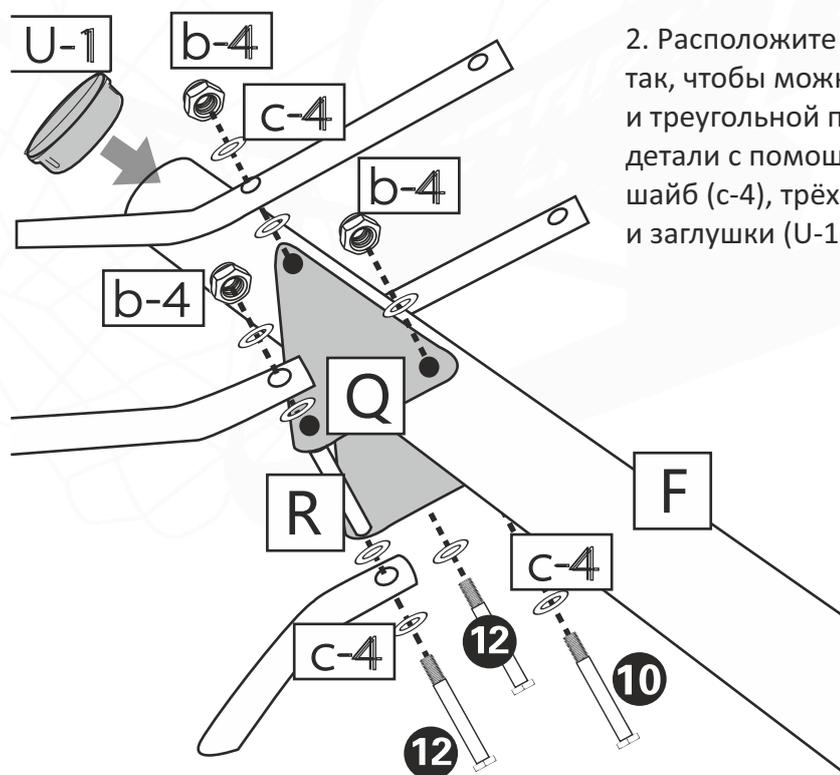
2. Расположите верхнюю стойку (F) между рычагами так, чтобы можно было прикрепить ее с рычагами и треугольной пластиной (Q), далее прикрепите все детали с помощью трёх болтов (№10,12), десяти шайб (c-4), трёх гаек (b-4), одной втулки (R), и заглушки (U-1).
