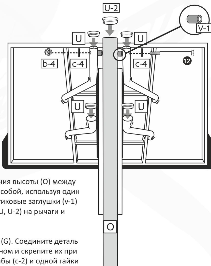
1. Расположите деталь для регулирования высоты (O) между верхними рычагами и скрепите их между собой, используя один болт (№12), две шайбы (c-4), две пластиковые заглушки (v-1) одну гайку (b-4). Установите заглушки (U, U-2) на рычаги и деталь для регулирования высоты.
